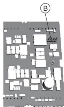
Rysunek 4.6: Umiejscowienie zwory masowej na spodzie
