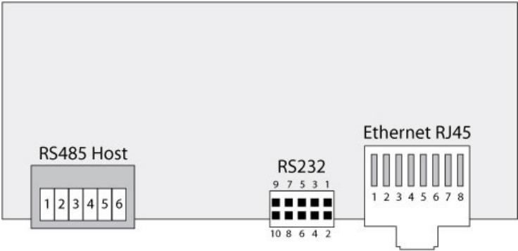
Rysunek 7.1: Złącza na górnej stronie płyty PCB
