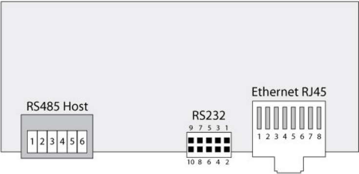
Rysunek 7.1: Złącza na górnej stronie płyty PCB
